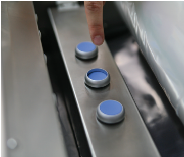
4 Sélection des couteaux « découpe transversale » selon le format des barquettes.
