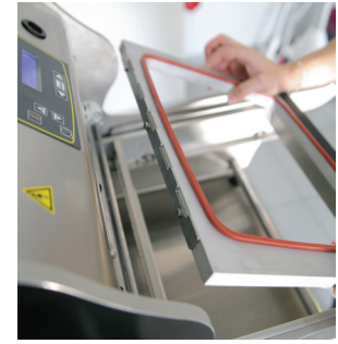
3 Mise en place des matrices de scellage.
