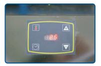
Cette scelleuse de barquette est équipée d'un clavier souple permettant de régler la température et le temps de scellage et le temps de soudure.
