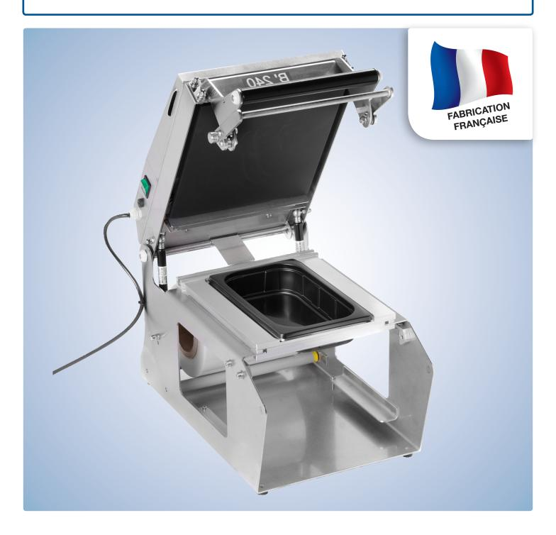
Scelleuse INOX pour la fermeture hermétique des barquettes de formats maxi 250 x 260 mm avec verrouillage mécanique.
