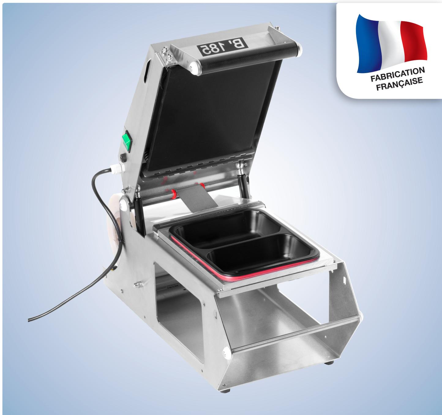
**Scelleuse INOX pour le conditionnement hermétique des barquettes de formats maxi 190 x 235 mm avec verrouillage mécanique.**
