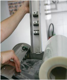
1 Mise en place de la bobine film.
