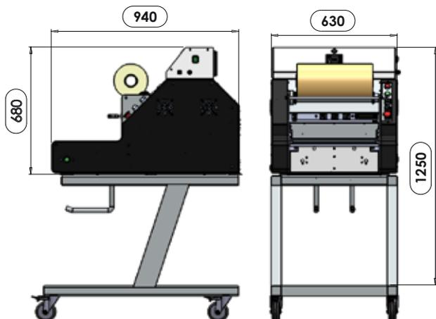
Châssis en aluminium anodisé, carter en inox et capot en ABS (version inox).
